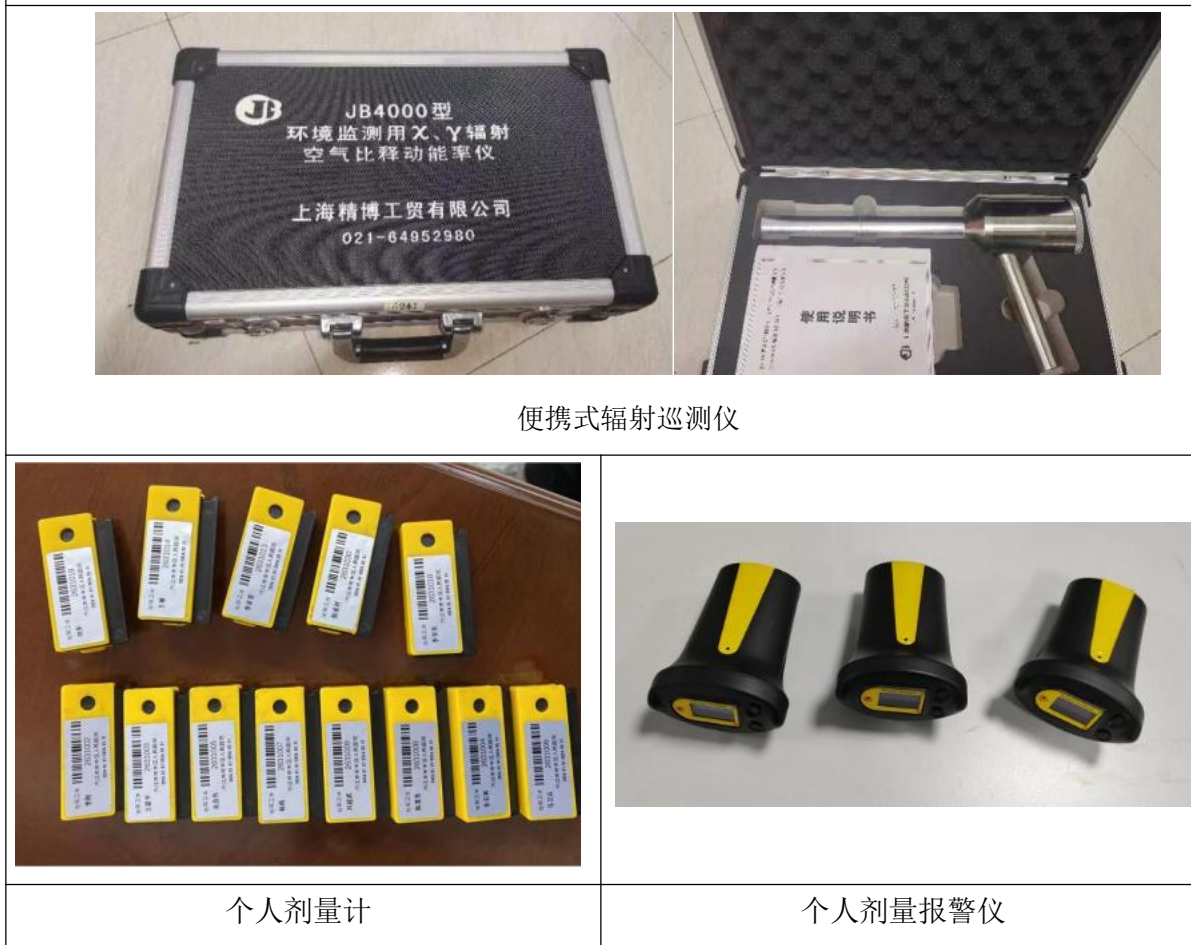
图 3-2 手术室配备的便携式 X-γ辐射检测
